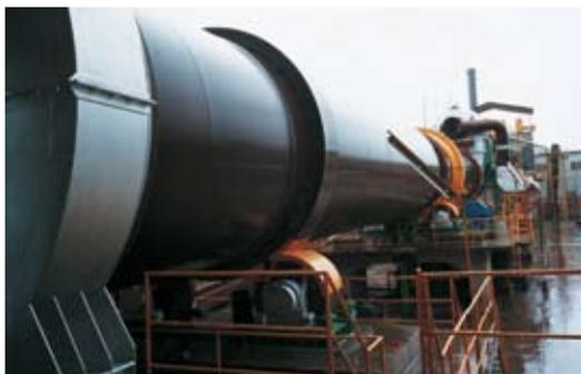
Forno rotante per la cottura e l'espansione dell'argilla espansa.
